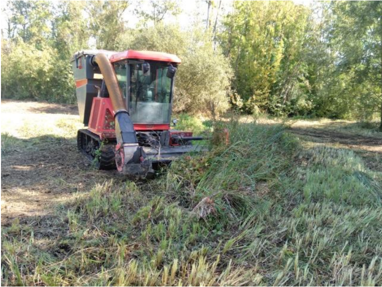
Figure 10 : broyeur exportateur en intervention – octobre 2025
